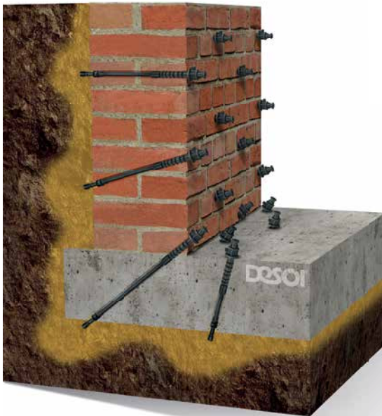
Schleierinjektion | Injection de voile
