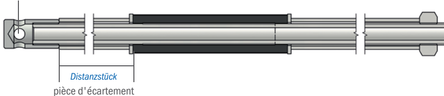
Endstück mit Querbohrung Ø 5 mm (4 x 90° versetzt) | Embout avec trous transversaux Ø 5 mm (4 x 90° décalés)
