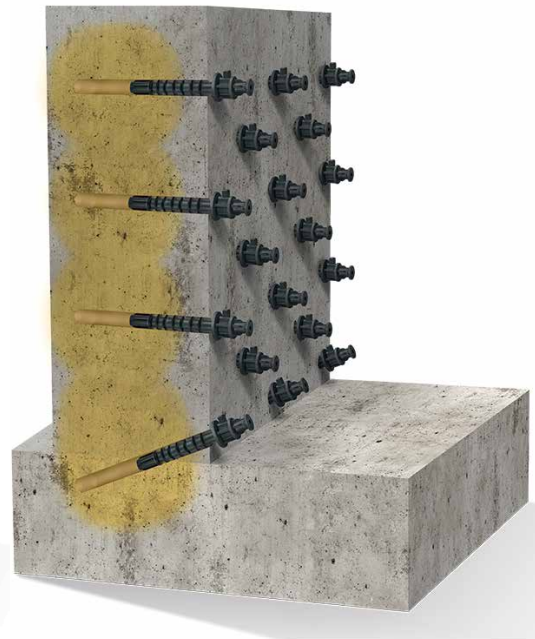
Flächeninjektion | Injection de maçonnerie
