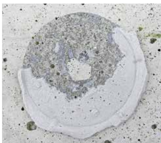
Sehr gute Adhesion auch zwischen Kleber und Packer Very good adhesion also between adhesive and packer
